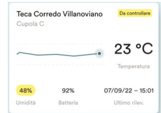
Consolle di monitoraggio delle condizioni micro-climatiche
